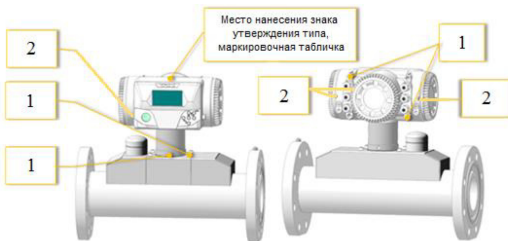
Рисунок 4 – Места пломбировки комплекса исполнения ВА с ИВБ исполнения базовый, с муфтовым присоединением, указание места нанесения знака утверждения типа, расположение маркировочной таблички
